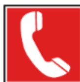
Téléphone pour la lutte contre l'incendie
