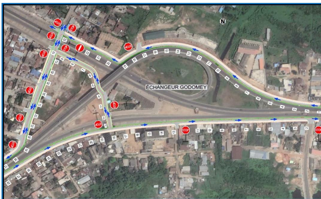
Figure 2 : Plan de circulation des contre-allées au niveau de l'échangeur Godomey
