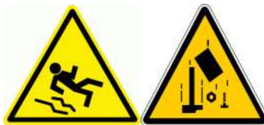
Figure 7-6: Panneaux indiquant des zones de glissade et de chute d'objets
