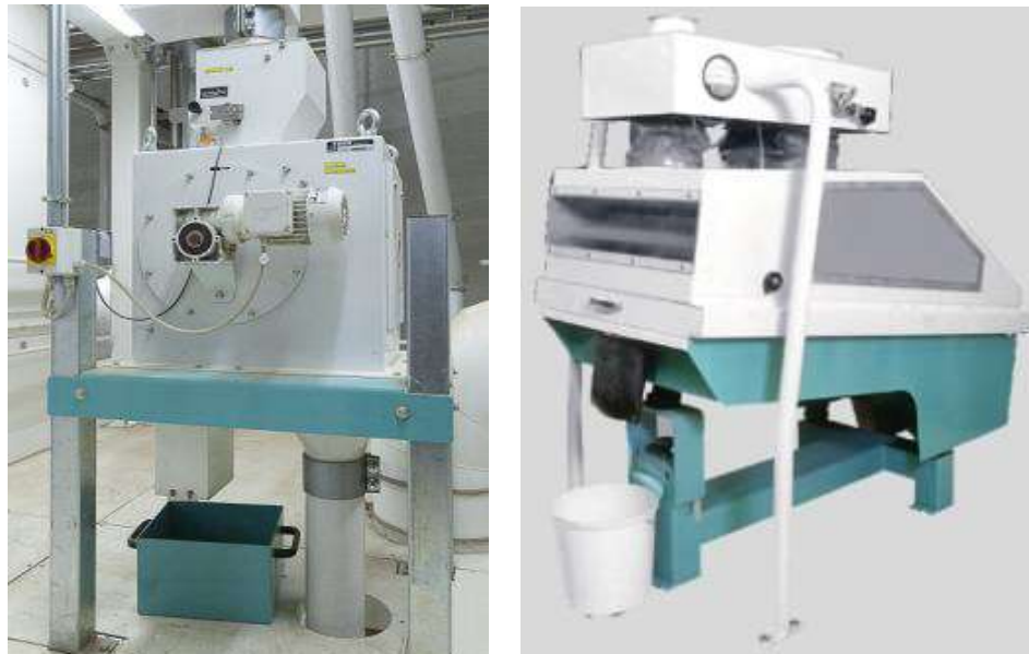
Photo 2-6: A- Tambour magnétique ; B- Epierreur Source : JB COCOA CI
