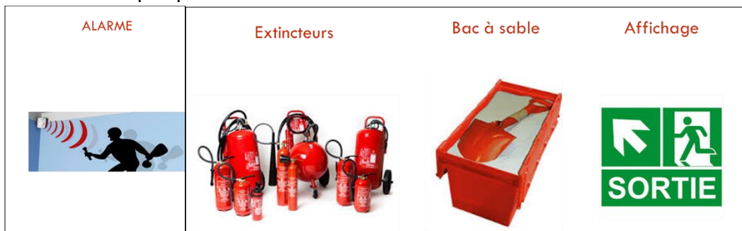
Figure 25: Équipements de protection collective
