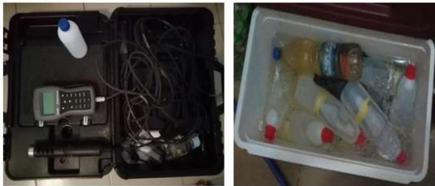
A. Sonde capteur Multiparamètre HI 9829
