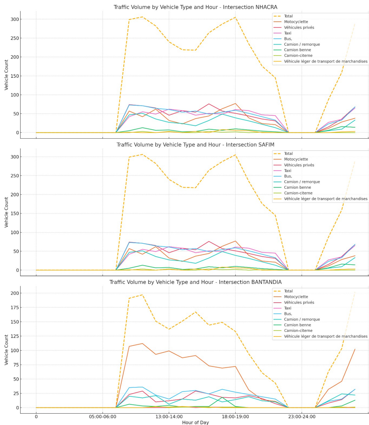
Figure 6-13 : Volume de trafic par heure et par type de véhicule aux trois principaux carrefours (SAFIM, NHACRA, BANTANDIA) (Source : Sufain Africa, 2025)
